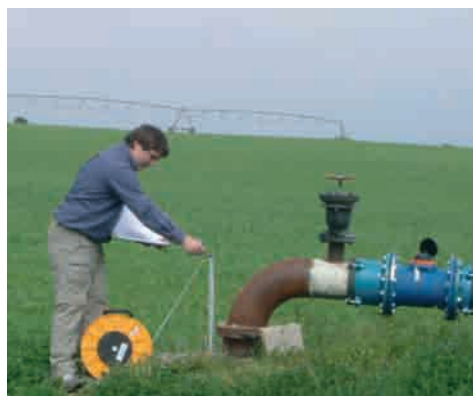
Medición del nivel al que se encuentra el agua en un sondeo.
